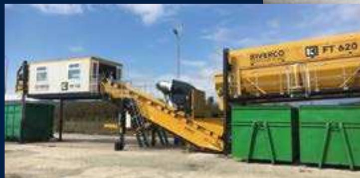
Le trommel FT Compact réalise le criblage initial des matériaux de toute nature, ce qui en fait une solution idéale pour une vaste gamme d'application.
