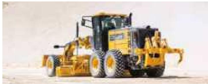
Ses nouvelles commandes EPC (manipulateur électrique) assurent à l'opérateur un confort de conduite inégalé. La visibilité de conduite depuis la cabine et sa prédisposition TOPCON (plug and play) en font une machine d'exception à découvrir.
