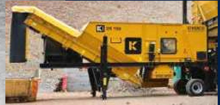
Le séparateur DS Compact a été conçu pour séparer avec efficacité les matériaux en fractions exploitables, à l'aide des plus récentes avancées dans la technologie de séparation aéraulique. Cette machine peut être combinée pour former un système de recyclage complet en ajoutant le trommel FT Compact et la station mobile de tri PS Compact.
