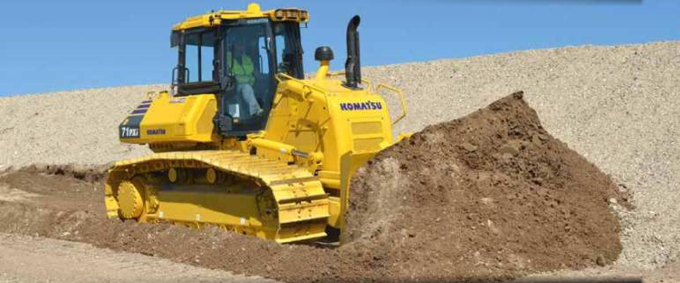
Les Bulls Komatsu bénéficient de la stabilité et motricité du train d'entraînement du fait d'un profil bas abaissant le centre de gravité. Ils disposent d'une cabine SpaceCab™ sécurisée, confortable, avec une excellente visibilité et dotée de commandes intuitives.
